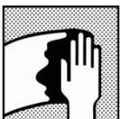
Oberflächenreinigung: Entfernen Sie vor dem Auftragen des Basislackes jegliche Oberflächenverunreinigungen, unter Verwendung eines geeigneten Oberflächenreinigers.
