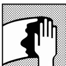
Entfernen Sie vor dem Auftragen von Decklack jegliche Oberflächenverunreinigung unter Verwendung entsprechender Oberflächenreiniger.
