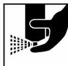
Nach Gebrauch Sprühdose wenden und Düse 2-3 Sekunden freisprühen.
