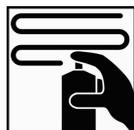
Sprühdose ca. 12-18 cm entfernt vom Teil halten und 2-3 gleichmäßige Schichten auftragen.
