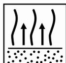
Zwischen den Schichten eine Abluftzeit von 5-10 Minuten bei 20°C gewähren.
