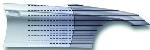
Die Auslaufzone größer anlegen und mit vermindertem Druck verhalten beispritzen.
