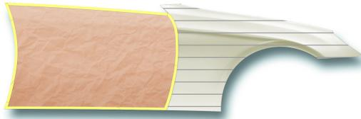
Angrenzendes Teil abdecken. Normale, einheitliche Schicht des gehärteten Grundfarbtons auftragen. Ablüften lassen.
