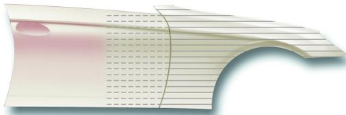
Die Abdeckung entfernen, den Spritzdruck auf 0,5 - 1,0 bar reduzieren und in das angrenzende Teil beilackieren. Ablüften und - falls erforderlich - diesen Schritt wiederholen. Abschließend den Grundfarbton trocknen oder länger ablüften, ca. 20 - 30 Minuten.
