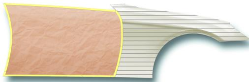
Den zweiten Spritzgang des gehärteten Grundfarbtons normal und einheitlich auftragen, um die endgültige Deckfähigkeit zu erreichen. Sofern die volle Deckfähigkeit nicht erreicht wird, kann dieser Schritt wiederholt werden.
