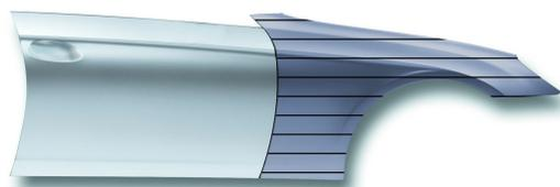
Reparaturzone mit Standox Basislack in einzelnen Spritzgängen lackieren.
