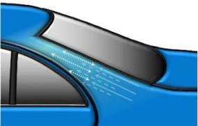
Beispritzen des reinen Performance Blend 5730 in dünnen Spritzgängen mit reduziertem Druck auf die Beilackierzone. Spritznebel des Klarlacks auflösen und einen weichen Übergang herstellen. Hierbei innerhalb der mit P3000 geschliffenen Fläche bleiben.
