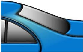
Beilackierzone und Übergangszone zur intakten Altlackierung mit z.B. 3M Trizact P3000 Fine Finishing Schleifscheiben oder ähnlichen Schleifmitteln anderer Hersteller schleifen.
