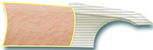
Die angrenzenden Teile abdecken. Den Standohyd-Plus-Basecoat-Grundfarbton vollständig deckend auf die neuen Teile auftragen.
